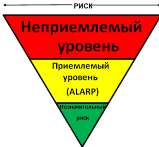
Рисунок 14 – Треугольник приемлемости риска
